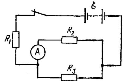
$R_3=3$  Ом. Амперметр показывает 0,48 А. Определить внутреннее сопротивление батареи.
